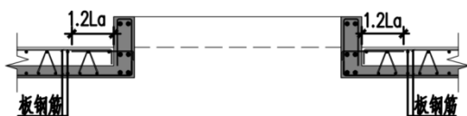
图5.3.10-1 叠合板水平连接(预制反梁)
